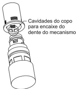
2. Cada **cavidade** representa uma vazão diferente, regular conforme (Fig.5).
