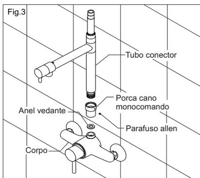
4. Encaixe o **braço móvel** no **tubo conector**. Ajuste a posição do braço móvel e fixe-o através do parafuso Allen. (Fig.4)
