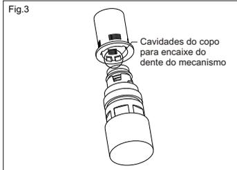
2. Cada **cavidade** representa uma vazão diferente, regular conforme. (Fig. 5)
